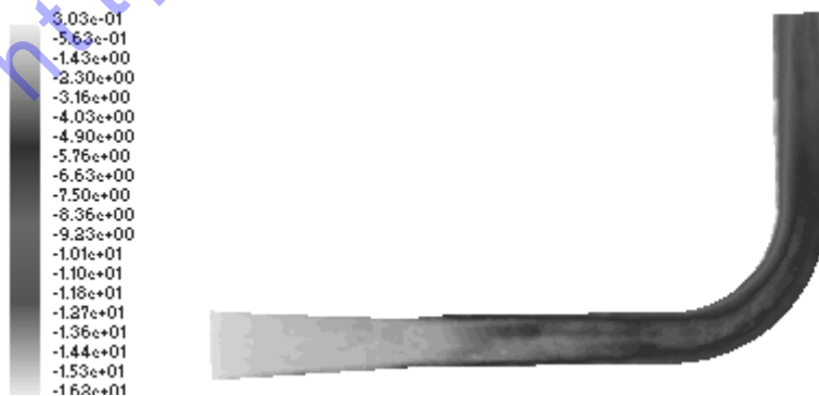
图 9 右线竖井排风联络风道水平剖面总压力分布云图
