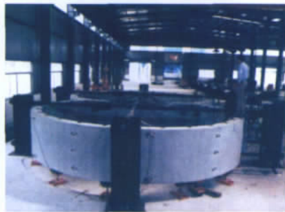
图 7 双圆盾构隧道管片模型试验 ① (2)
