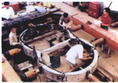
图 6 双圆盾构隧道管片模型试验 ① (1)
